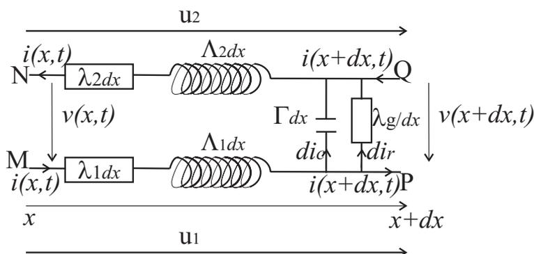
FIG. 7 - Schéma d'une portion de câble de longueur  $dx$
