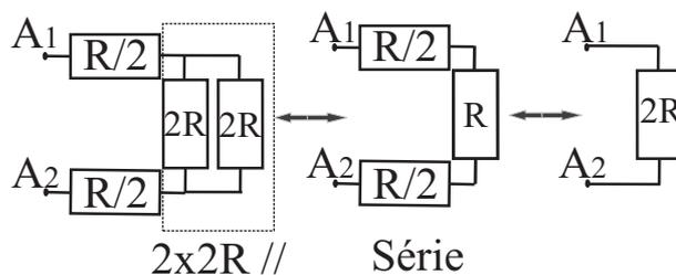
FIG. 3 - Détermination de  $R_1$
