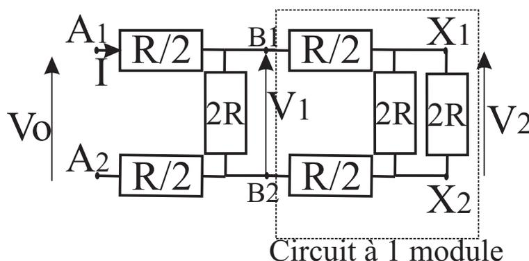
FIG. 6 - Schéma électrique pour deux modules
