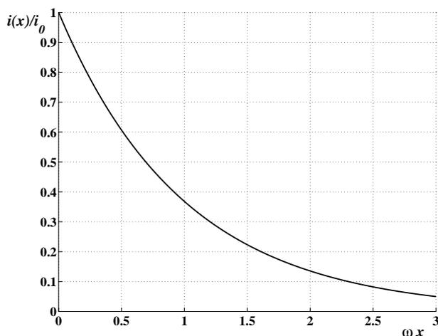
FIG. 1 - Evolution schématique du courant le long du câble
