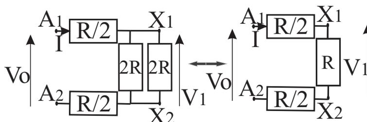
FIG. 5 - Schéma électrique équivalent à un module
