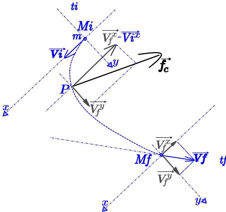
Figure 3 – Schéma de la force  $\vec{f}_c$  agissant sur la sonde pour la changer de trajectoire
