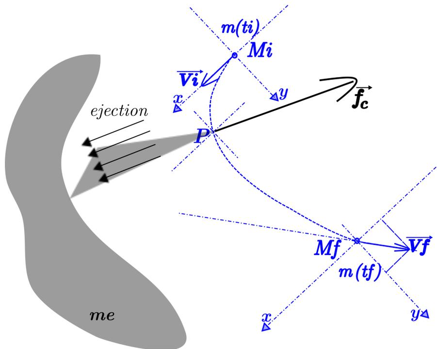
Figure 4 – Schéma de la sonde et du gaz éjecté (en gris) entre les deux instants  $t_i$  et  $t_f$ .
