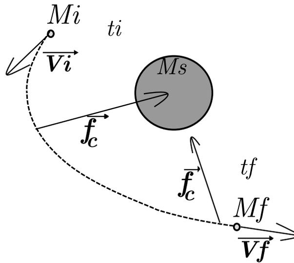
Figure 5 – La sonde dans un environnement gravitationnel. La force de gravitation  $\vec{f}_g$  est centrale vers le centre du corps stellaire. Elle n'est pas constante en norme, elle décroît comme l'inverse de la distance  $r^2$ .
