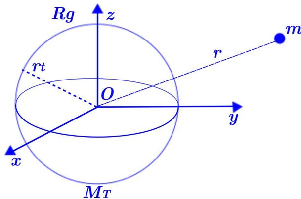
Figure 2 – Schéma d'un corps massif de la masse  $m$  dans le champ de gravitation terrestre. Le référentiel est le référentiel géocentrique  $R_g$ , le rayon de la terre  $r_t$ , la masse de la Terre  $M_T$ , la distance de point massif au centre de la Terre est  $r$ .
