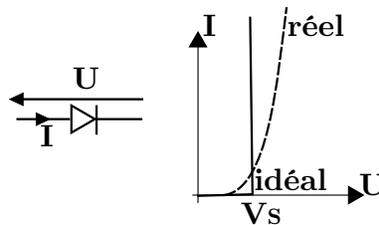
FIGURE 3 – Caractéristique électrique de la diode (en pointillé, la caractéristique réelle, en plein la caractéristique idéale)
