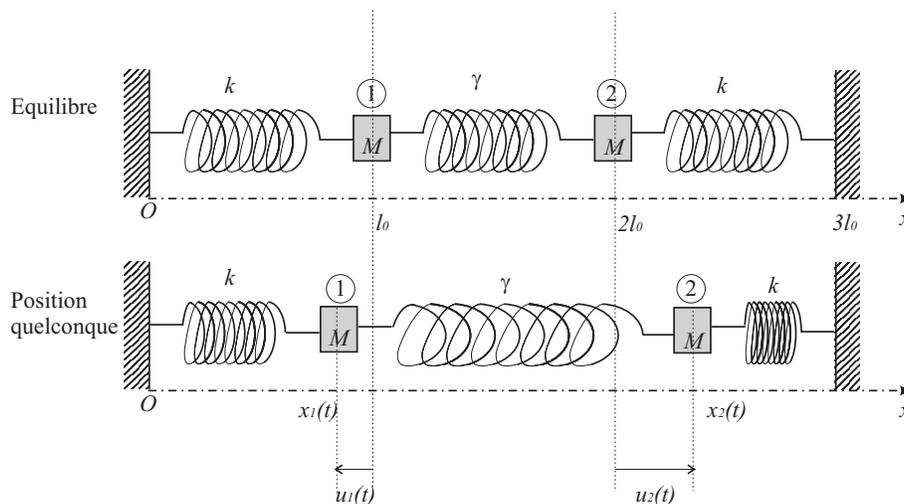
FIGURE 1 – *Système d'oscillateurs mécaniques couplés*
