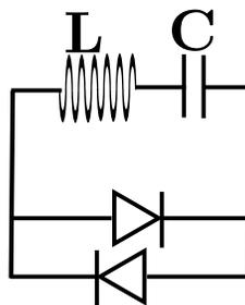
FIGURE 4 – Circuit oscillant avec amortissement non-linéaire
