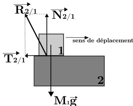
FIGURE 2 – Représentation des réactions entre deux pièces solides
