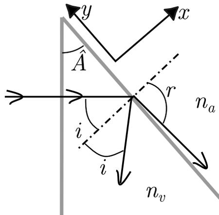
FIGURE 4 – Prisme en gris. L'indice du verre  $n_v \sim 1,5$ , l'indice de l'air  $n_a \sim 1$ .
