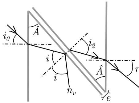
FIGURE 5 – Accolement de deux prismes.  $e$  est la distance séparant les deux prismes
