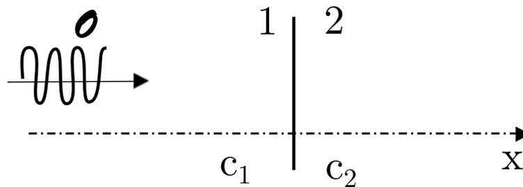
FIGURE 2 – Schéma de la figure de la réflexion et la réfraction d'une onde sur une interface plane
