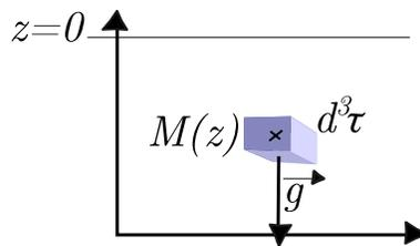
FIGURE 1 – Schéma d'un élément infinitésimal de volume autour d'un point du fluide
