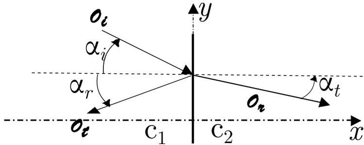
FIGURE 3 – Schéma de la réflexion d'une onde en incidence quelconque
