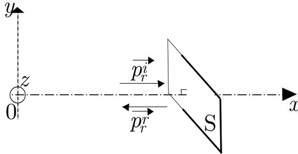
FIGURE 3 – Variation de l'impulsion du rayonnement lors d'une réflexion.
