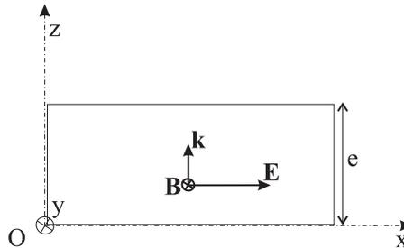
FIGURE 1 – Schéma de la propagation d'une onde plane dans une lame métallique
